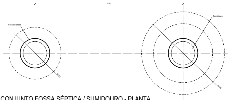
CONJUNTO FOSSA SÉPTICA / SUMIDOURO - PLANTA ESC.1:25
